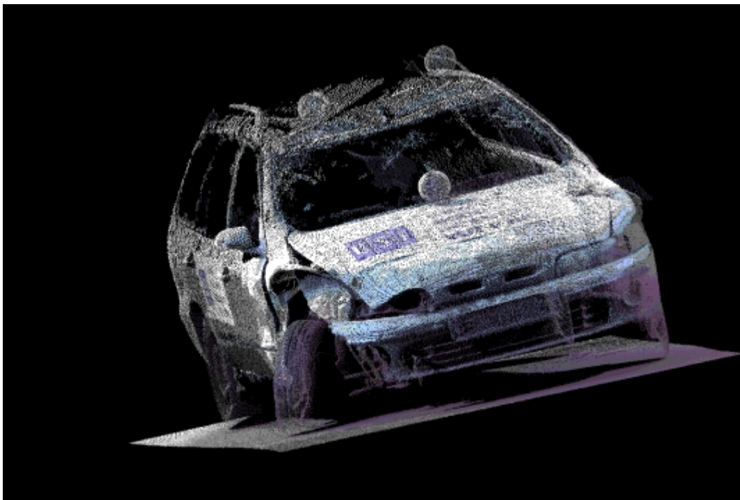
Obr. 3 - Fotografická interpretace 3D modelu havarovaného vozidla
