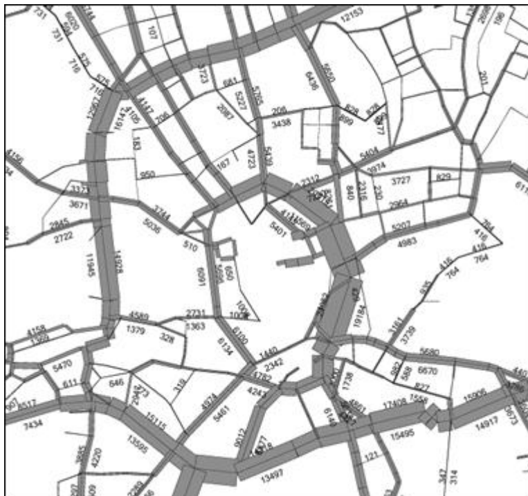
Obrázek 1 Výsledky modelování dopravních objemů v centru Brna.
