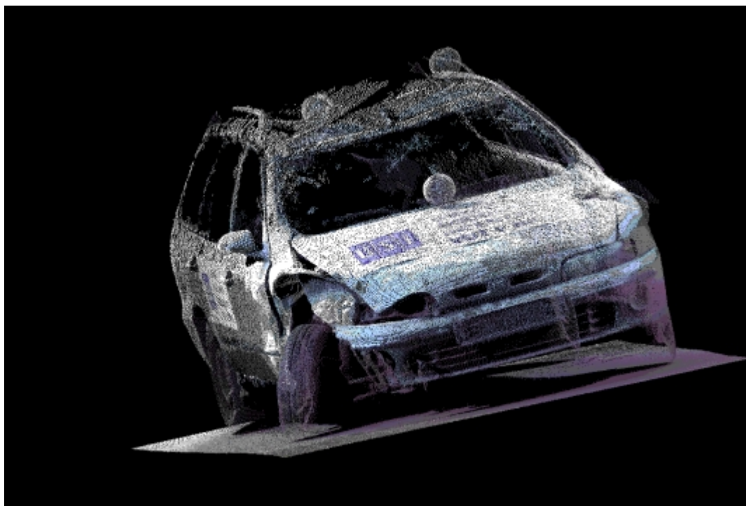
Obr. 3 – Fotografická interpretace 3D modelu havarovaného vozidla
