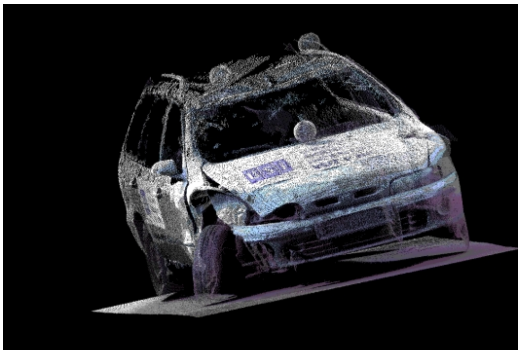
Obr. 3 – Fotografická interpretace 3D modelu havarovaného vozidla
