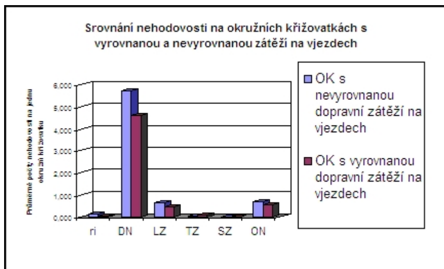
Graf: Srovnání nehodovosti na okružních křižovatkách s vyrovnanou a nevyrovnanou zátěží na vjezdech
