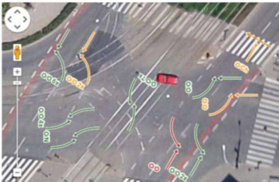
Příklad části konfliktního diagramu na podkladu ortofotomapy
