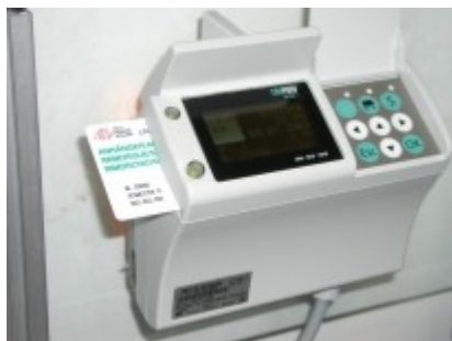
Obr. 1: OBU – palubní jednotka On Board Unit
