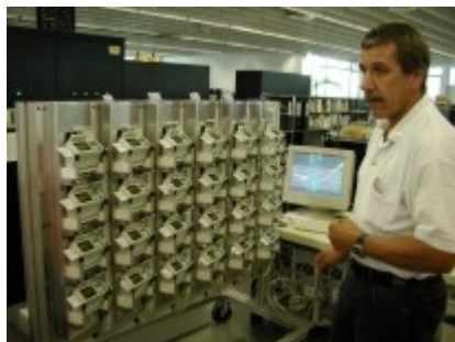
Obr. 6: Testování OBU ve výrobním závodě FELA
